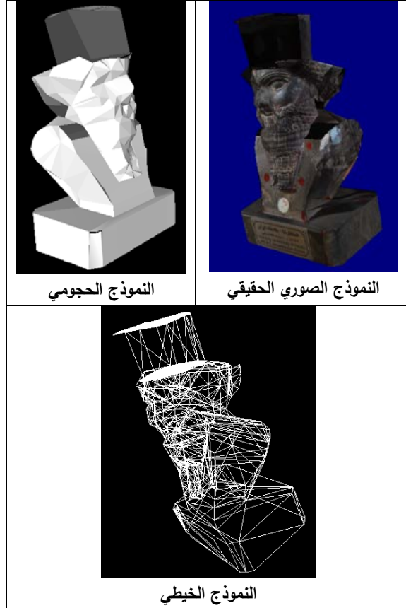
الشكل (6) مراحل بناء النموذج ثلاثي الأبعاد لتمثال كسرى. 4-5- تقييم دقة النماذج ثلاثية الأبعاد
